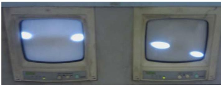
Рис. 12. Изображения 1.1 мА пучка электронов (слева) и 0.3 мА пучка позитронов (справа) на мониторах СИ при включенном ВЧ разведении с амплитудой напряжения на пластинах 6.5 кВ. Система электростатического разведения полностью выключена.
