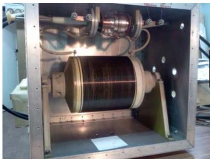
Рис. 7. Вид катушки, помещённой внутрь блока резонансного контура со снятым и не показанным кожухом воздушного охлаждения. Кожух охватывает катушку с зазором 4 мм для обдувания витков сжатым воздухом, поступающим через торцевое сопло (расход 30 л/сек). Вверху блока находится механически регулируемая емкость контура величиной 300 пкФ.
