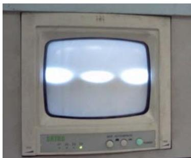
Рис. 10. Наблюдение двух электронных банчей по СИ, отстоящих друг от друга на пол-оборота в кольце ВЭПП-4М, при включенной системе ВЧ разведения. Один из банчей проходит пластины разведения в максимуме ВЧ напряжения, другой - при нулевом напряжении. В результате на экране СИ-монитора этот пучок отображается в двух своих крайних положениях, а второй находится в центре. Частоты бетатронных колебаний:  $Q_x = 0.535$ ,  $Q_y = 0.584$ .
