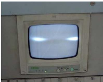
Рис. 9. Изображение электронного сгустка с энергией 1.85 ГэВ на мониторе СИ при амплитуде напряжения на пластинах ВЧ разведения около 6.5 кВ, Радиальная бетатронная частота  $Q_x = 0.53$ . Между положениями орбиты сгустка около 7 мм (на азимуте монитора  $\beta_x = 1200$  см).
