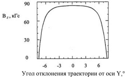
Рис. 5. Поле вдоль траектории электрона в медианной плоскости (магнит 8.416 Тл).
