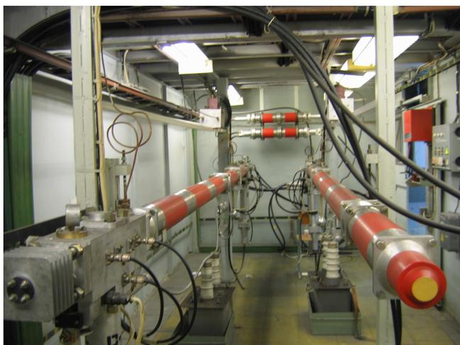
Рис. 6.8: Внешний вид наносекундных импульсных генераторов.
