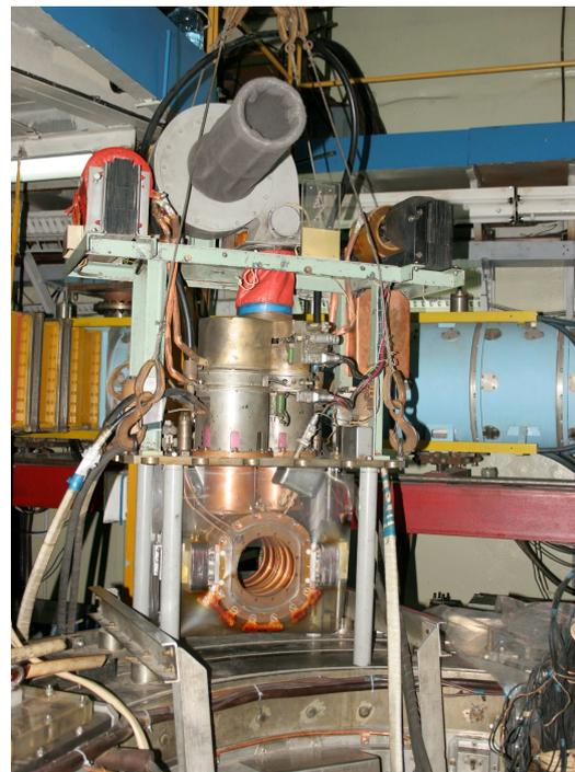
Рис. 4.16: Конструктивная схема (а) и внешний вид (б) ускоряющей системы Б-4: 1 – резонансные секции; 2 – ферриты; 3 – магнитопровод электромагнита; 4 – обмотка электромагнита.
