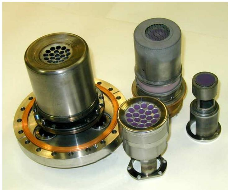
Рис. 4.6: Пушка с многоячейстым катодом.
