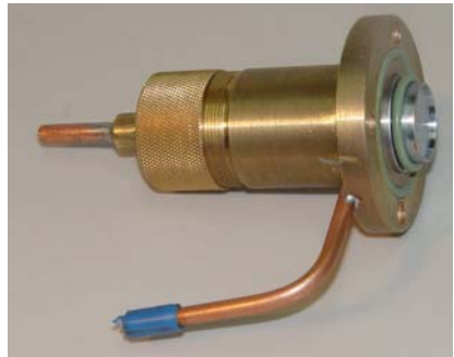
Рис. 3. Узел транспортировки образца: 1 – сопло, 2 – накидная гайка, 3 – корпус, 4 – поршень, 5 – место для помещения образца.
