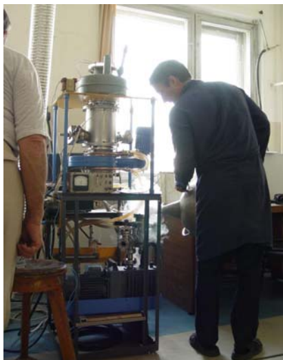
Рис. 2. Экспериментальный стенд изучения напыления лития на мишень (слева) и узел мишени с системой напыления.
