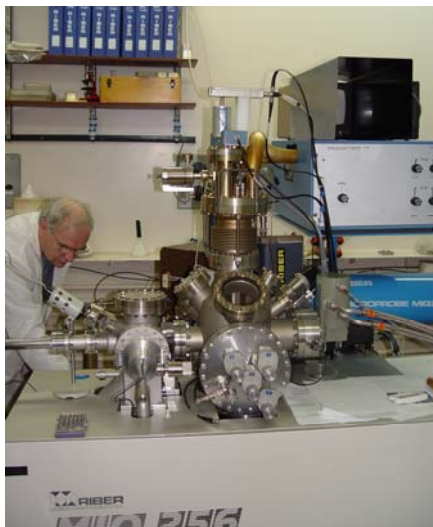
Рис. 5. Масс-спектрометр вторичных ионов квадрупольного типа Riber MIQ-256.
