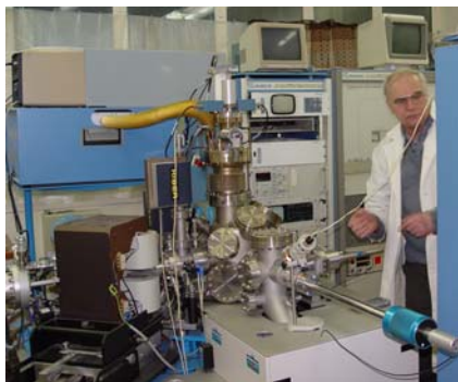
Рис. 5. Масс-спектрометр вторичных ионов квадрупольного типа Riber MIQ-256.
