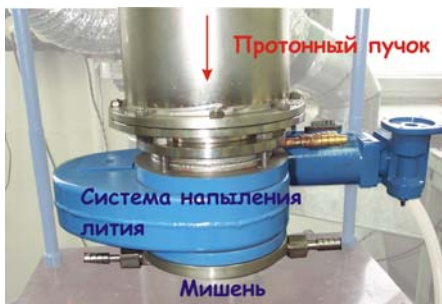
Рис. 2. Экспериментальный стенд изучения напыления лития на мишень (слева) и узел мишени с системой напыления.
