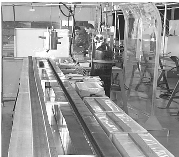
*Рис. 3. Сверху – Bus-Bar’ы с запаянным сверхпроводником; на поверхности шины уложена электрическая изоляция. Снизу – линейная часть линии пайки; на заднем плане виден тигель, служащий источником/приёмником расплавленного припоя.*
