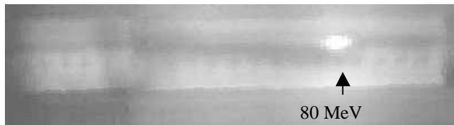
Рис. 12. Ускоренный пучок при работе с ВЧ группирователем.
