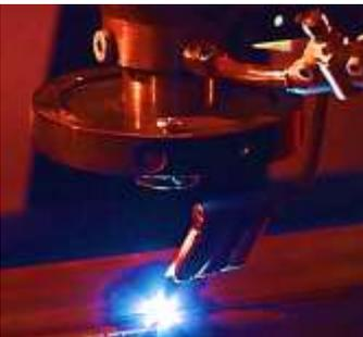
Процесс лазерной сварки Al-Li сплава 3 поколения (ИПТМ СО РАН).
