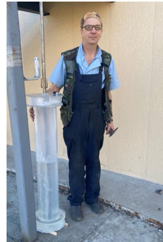
Изготовление вакуумного тест-объема ускорителя. Стадия изготовления — полимеризация объема вместе с фланцами.
