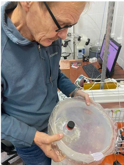
Заготовка для вакуумного фланца
