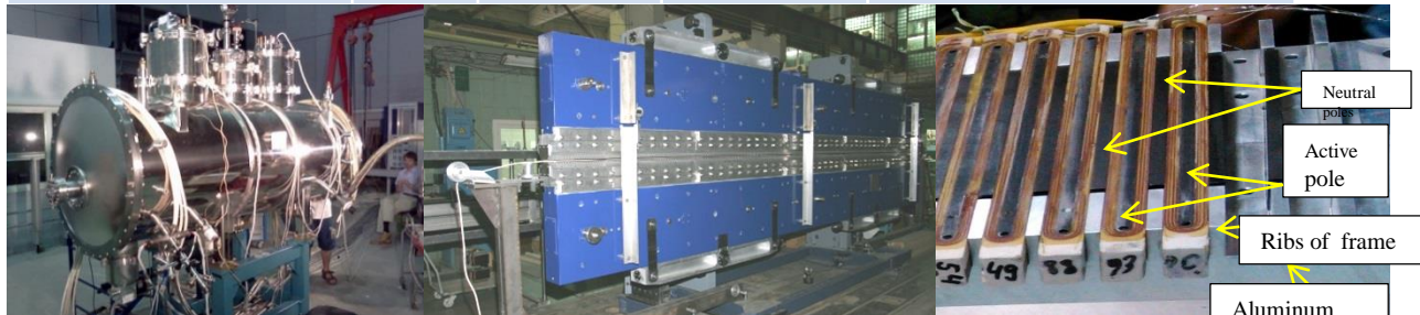
Сверхпроводящий 72-полюсный вигглер с полем 3Т для источника СИ ANKA в Карлсруэ
