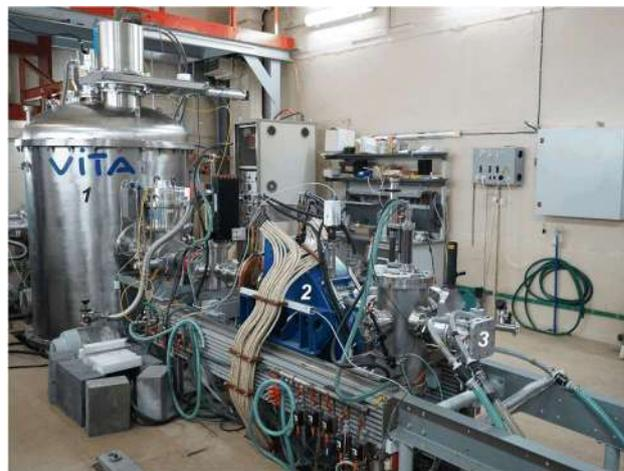
Рисунок 2. Фотография источника нейтронов VITA в ИЯФ СО РАН: 1 – ускоритель-тандем с вакуумной изоляцией, 2 – поворотный магнит, 3 – литиевая мишень
