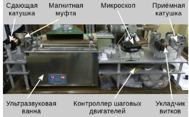
Рис. 10: Новый перемоточный станок с возможностью ультразвуковой мойки.
