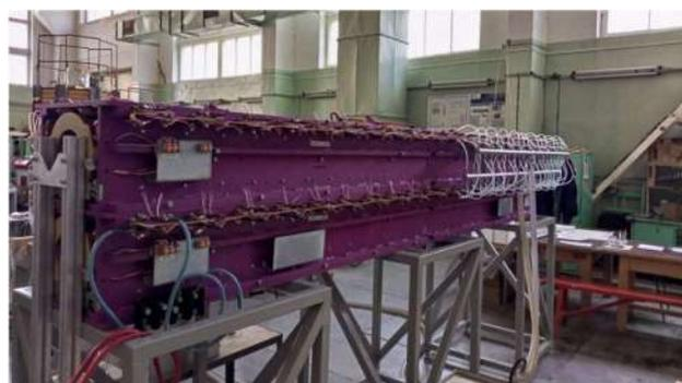
Рисунок 2. Прямолинейный транспортный канал магнитного поля в процессе подготовки к магнитным измерениям.
