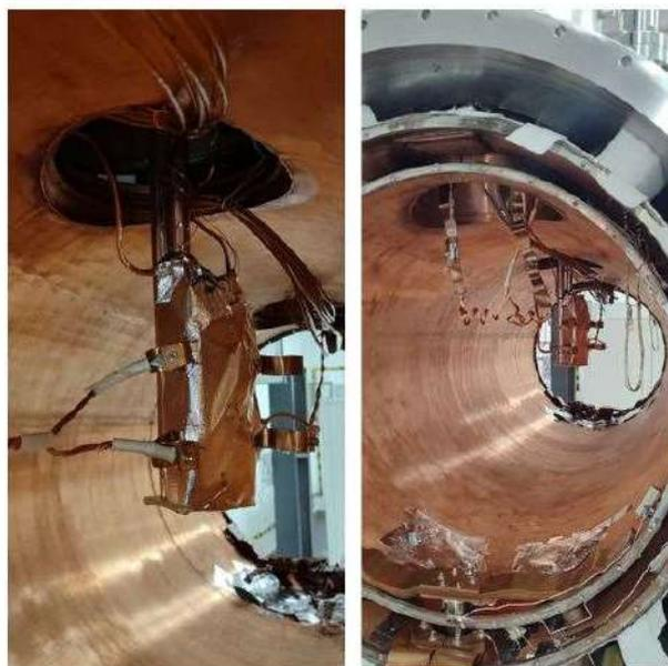
Рисунок 5. Внешний вид двух-апертурного блока ССТ линз, собранного в «сухом» криостате для проведения магнитных измерений.
