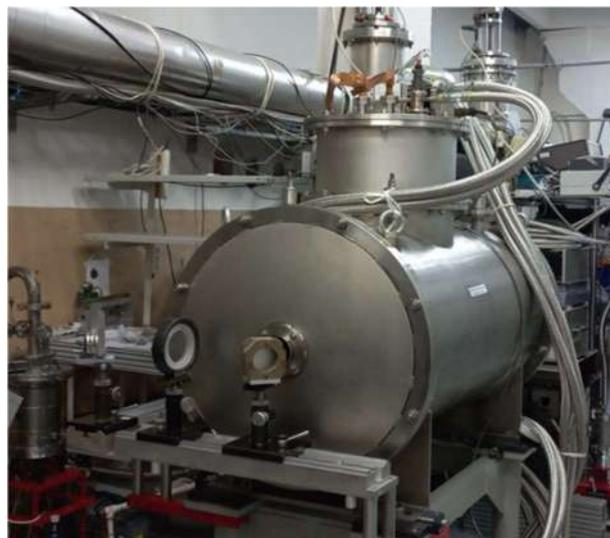
Рисунок 5. Сверхпроводящий соленоид на станции молекулярной спектроскопии.
