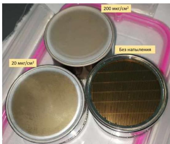
Рисунок 3. Сравнение ФЭУ R6041-506MOD без напыления и с напылением ТФБ толщиной 20 мкг/см<sup>2</sup> и 200 мкг/см<sup>2</sup>.
