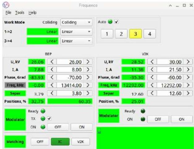
Рисунок 17. Главное окно операторского приложения для управления ВЧ-системой ВЭПП-2000.
