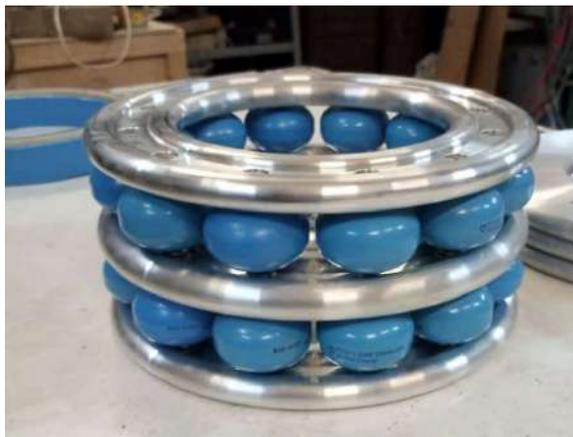
Рисунок 1. Сборка конденсаторов для ВЧ генераторов, синее кольцо на заднем фоне – вышедший из употребления разделительный конденсатор.
