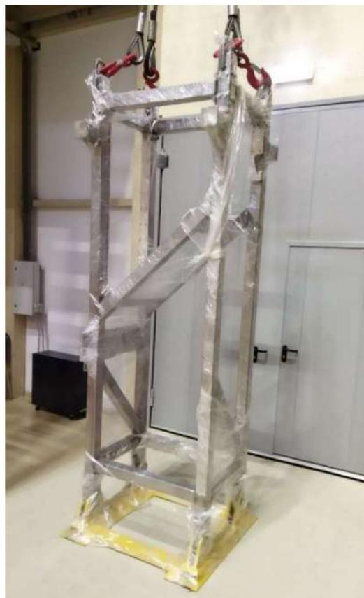
Рисунок 2. Оборудование для перемещения порт-плага верхних портов.
