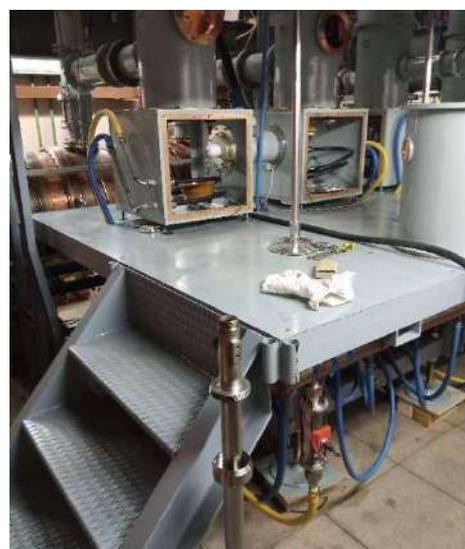
Рисунок 4. Рама ВЧ генератора.
