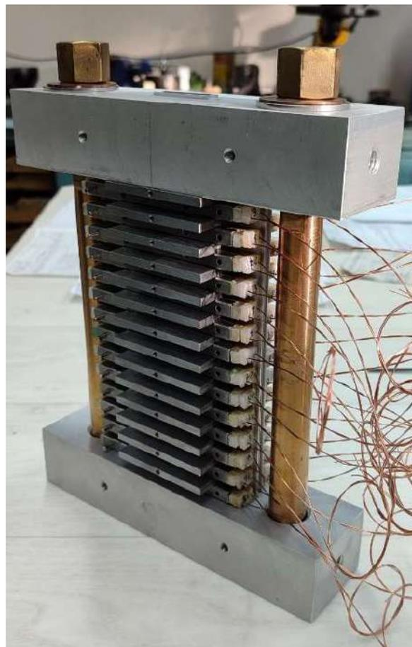
Рисунок 7. Внешний вид прототипа сверхпроводящего ондулятора с периодом 12 мм в процессе сборки.
