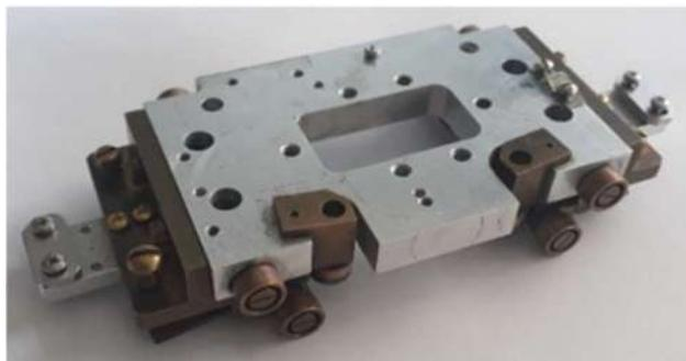
Рисунок 5. Элементы системы перемещения датчика магнитного поля.
