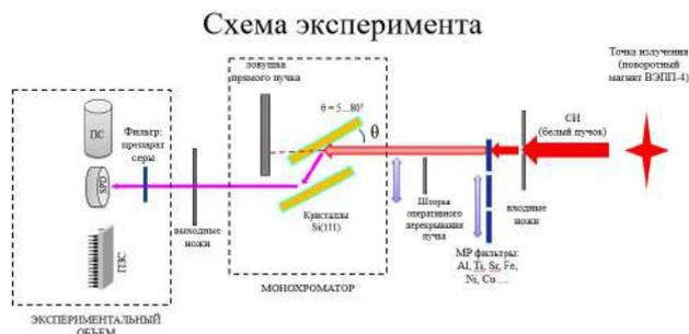
Рисунок 36. Схема измерения чувствительности пропорционального счетчика.
