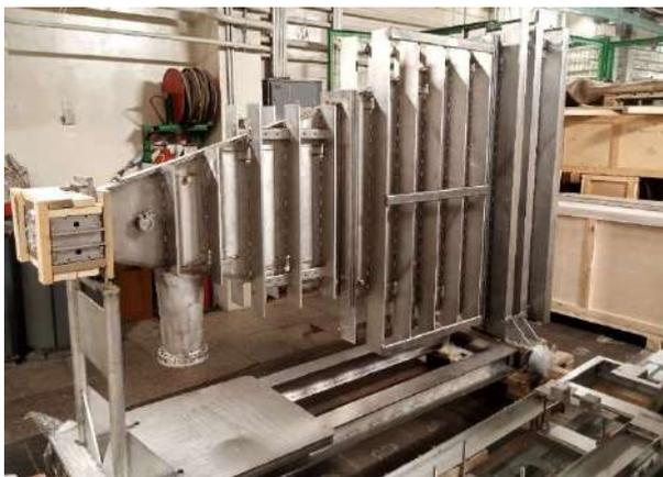
Рисунок 9. Изготовленная в 2024 году система выпуска пучка для ускорителя ИЛУ-14.
