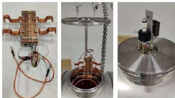
Рисунок 4. Процесс сборки двух-апертурного блока ССТ линз для проведения магнитных измерений в «сухом» криостате.
