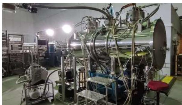
Рисунок 3. Внешний вид вигглера с полем 2,7 Тл и периодом 27 мм во время испытаний.
