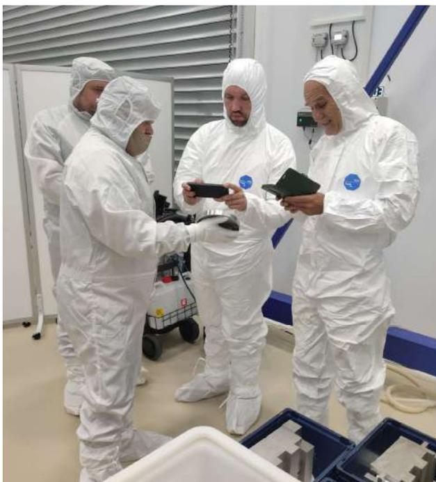
Рисунок 3. Финальная очистка элементов диагностики АНЧ, имеющих статус оборудования важного для ядерной безопасности, в чистом сборочном помещении в присутствии двух внешних инспекторов. Помещение соответствует классу ИСО 7 по ГОСТ Р ИСО 14644-1-2017 и Level I work area согласно французским правилам для ядерного оборудования RCC-MR 2007.
