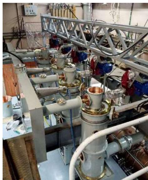
Рисунок 5. ВЧ генератор на раме.
