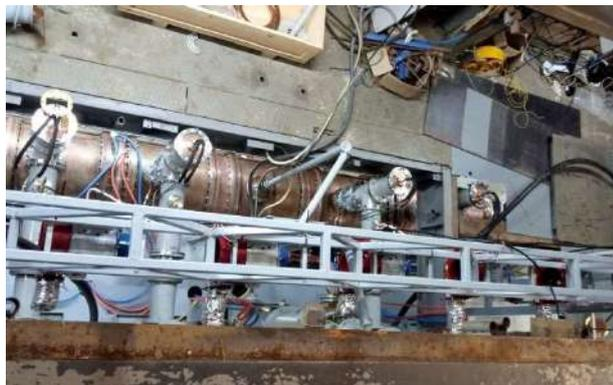
Рисунок 2. Ускоряющая структура и вводы ВЧ мощности – вид сверху.
