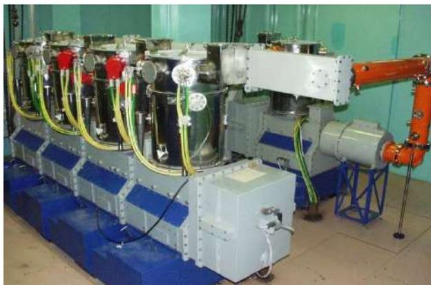
Рисунок 1. Один из выходных каскадов ВЧ генератора с четырьмя тетрами (в цилиндрических кожухах). На заднем плане виден старый предусилитель, подключённый коаксиальным волноводом.
