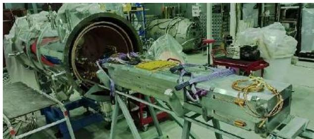
Рисунок 1. Процесс установки магнита вигглера с полем 4,5 Тл и периодом 48 мм в корпус собственного криостата.
