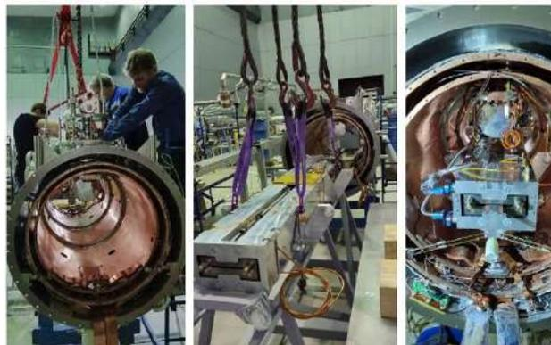
Рисунок 2. Процесс сборки вигглера с рабочим полем 2,7 Тл и периодом 27 мм в собственном криостате на основе косвенного охлаждения.
