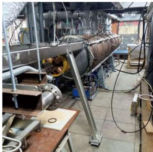
Рисунок 3. Ускоряющая структура с вводами ВЧ мощности – вид сбоку.
