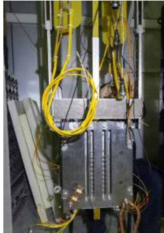
Рисунок 2. Короткий прототип сверхпроводящего вигглера с периодом 48 мм и полем 4,2 Тл для синхротрона SOLARIS, перед испытанием в жидком гелии.
