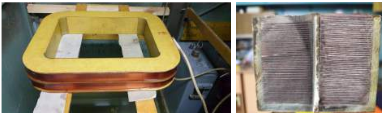
Рисунок 12. Секция обмотки ВН модернизированного ТСТ 400-10000/36 и ее разрез.
