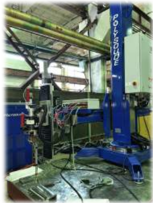
Рисунок 5. Схема и фотография комплекса автоматической сварки. Основное предназначение комплекса – сварка фланцев на гермоплите порт-плага и крышек каналов водяного охлаждения ДЗМ сложной формы.
