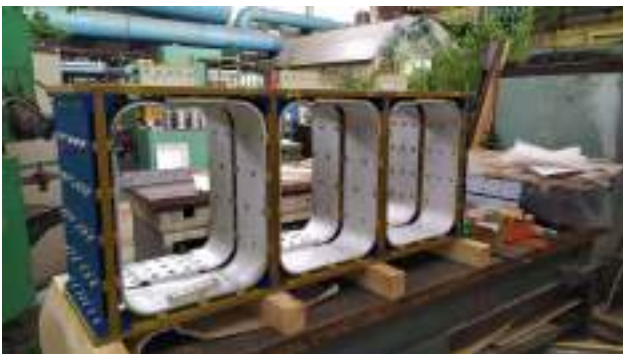
Рисунок 14. Каркас со вторичными обмотками модернизированного ТСТ 400-10000/36.
