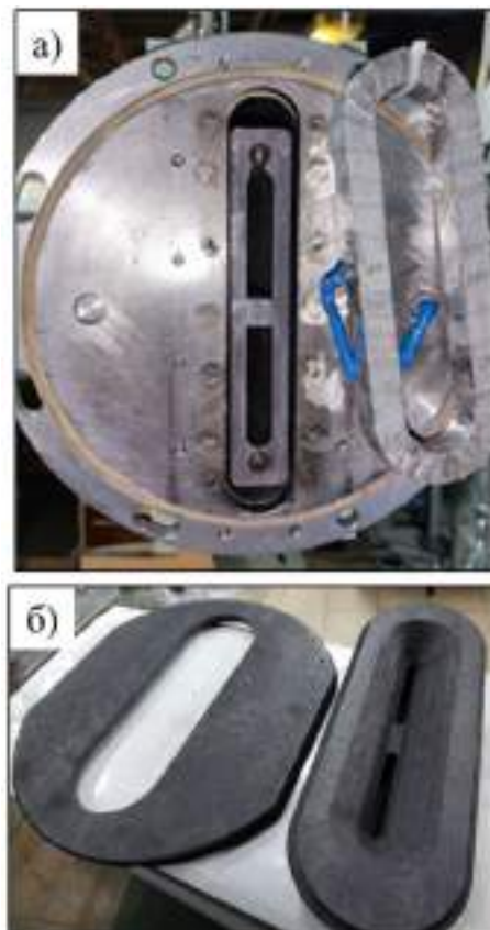
Рисунок 6. Фотография элементов ускорительного магнитно-изолированного диода, предназначенного для одновременной генерации двух ленточных пучков. (а) – место присоединения к ускорительному диоду вакуумного канала с миллиметровой и терагерцовой секциями, расположенными одна над другой по вертикали. (б) - графитовые детали анодной щели для двухпучкового диода.
