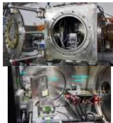
Рисунок 12. Монохроматор на Si(111) кристалле-бабочке и управляемые рентгеновские щели.
