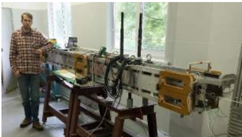
Рисунок 19. Ондюлятор на стенде окончательной настройки. Видны жёлтые корректирующие катушки.
