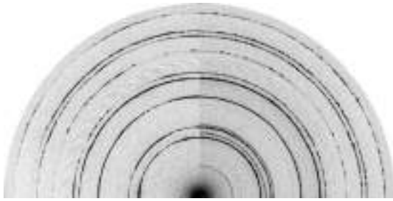
Рисунок 40. Фрагменты дифракционных картин, полученных от участка сварного соединения сплава В-1424 во время термообработки при различных температурах
