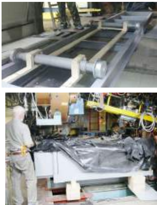
Рисунок 6. Вверху: катки и рельсы для перемещения нижнего плеча АКС. Внизу: АКС, задвинутый под медианную плоскость накопителя ВЭПП-3.
