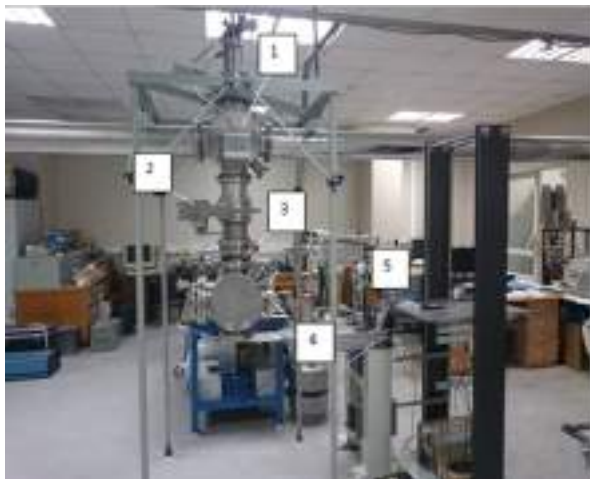
Рисунок 24. Устройство перископического поворотного вывода излучения: 1 – подвижное зеркало, 2 – шибер, 3 – поворотный механизм, 4 – выходное окно, 5 – станция «Исследования химических радикалов».
