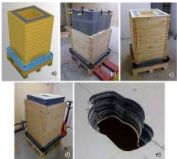
Рисунок 23. Общий вид концентратора: а) трехмерная модель (крышка не показана); б) и с) концентратор в процессе сборки; д) полностью собранный концентратор с установленной свинцовой крышкой; е) отверстие в крышке концентратора для ввода мишенного узла.
