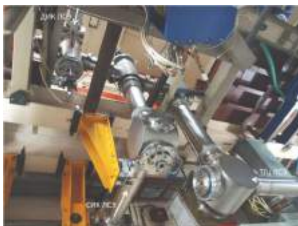
Рисунок 22. Оптический коммутатор с двумя подвижными зеркалами. Белыми стрелками показаны направления распространения внутри труб излучения первого (ТГц), второго (ДИК) и третьего (СИК) ЛСЭ.
