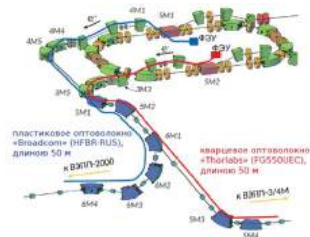
Рисунок 3. Схема расположение датчиков потерь пучка в каналах транспортировки К-500.
