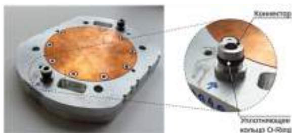
Рисунок 21. Общий вид медной подложки, установленной в основание мишенного узла.
