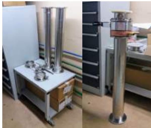
Рисунок 18. Изготовленные части вакуумной камеры (слева) и частично собранная камера в области подключения мишенного узла (справа).
