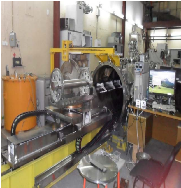
Рис. 5.5.1. Установка электронно-лучевой сварки. На переднем плане – механизм перемещения свариваемой детали.
