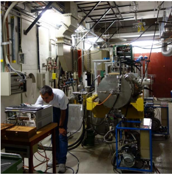
Рис. 7.4.1. Подготовка модуля CCDTL к испытаниям в защищенном бункере ЦЕРН.
