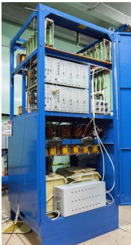
Рис. 7.6.3. Шкаф низковольтных источников питания с выпрямителем вольтодобавки напряжения смещения (внизу).
