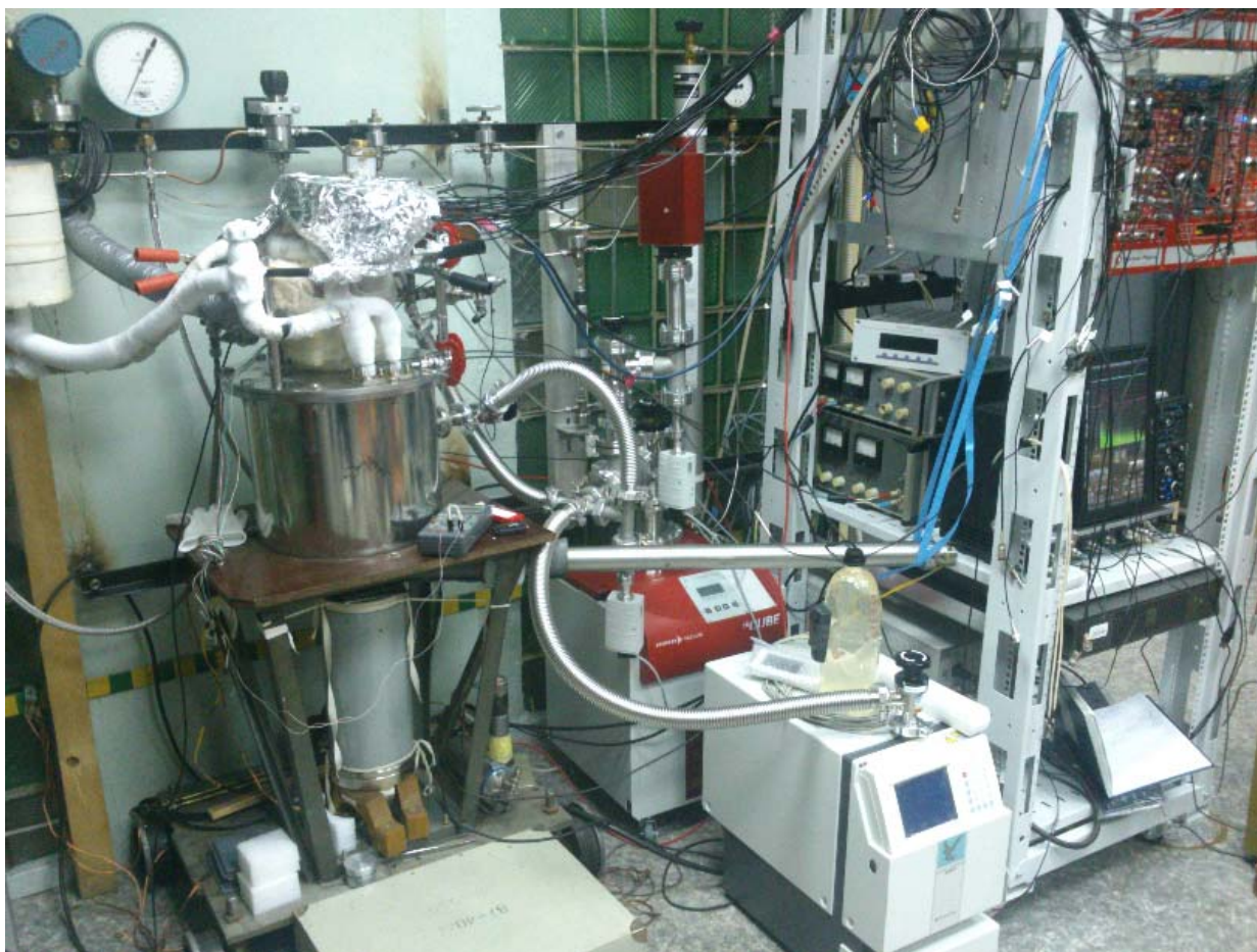
Рис. 1.4.2. Внешний вид экспериментальной установки с двухфазным КЛД с криогенной камерой объемом 9 л и нейтронным генератором (длинная труба под двухфазным КЛД).
