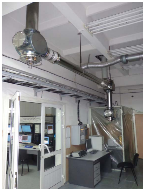
Рис. 6.4.5. Вывод излучения на второй этаж. Объемы, где помещены зеркала, соединяются трубами и имеют юстировочные узлы.
