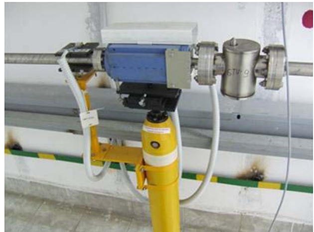
Рис. 5.1.3. Узел на канале К-500, состоящий из дипольного корректора, квадрупольной линзы и люминофорного датчика.
