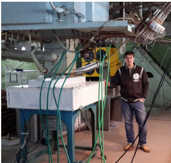
Рис. 8.4.10. Установка для нанесения антикоррозионной наплавки Ta на титановый сплав.
