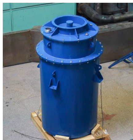
Рис. 6.4.3. Новый высоковольтный выпрямитель для электростатической электронной пушки.
