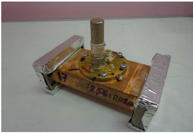
Рис. 5.3.4. Направленный волноводный ответвитель.
