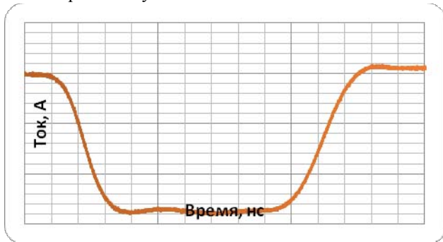
Рис. 5.4.13. Форма тока второго импульса на выходе из электронной пушки.
