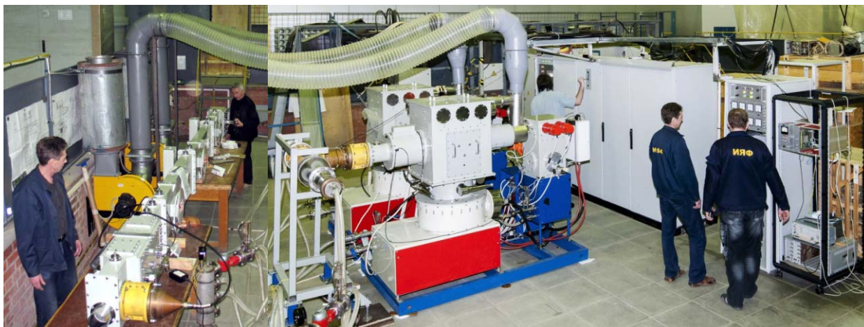
Рис. 7.8.1 Стенд для испытаний генераторных модулей для РФЯЦ-ВНИИЭФ.
