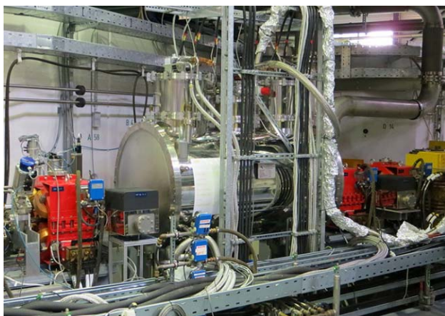
Рис. 6.5.1. 40-полюсный вигглер с полем 2,5 Тл и периодом 48 мм установлен на накопителе ANKA (Карлсруэ, Германия) для исследований по спектроскопии.
