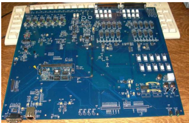
Рис. 7.1.1. Фотография печатной платы контроллера ВЧ-станций бустера NICA.
