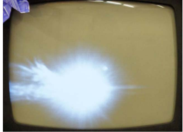
Рис. 5.3.13. Фотография синхротронного излучения из накопителя-охладителя ИК ВЭПП-5.
