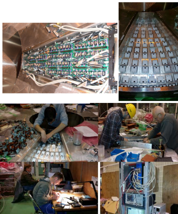
Рис. 1.8.8. Этапы разборки сектора калориметра и замены резисторов.
