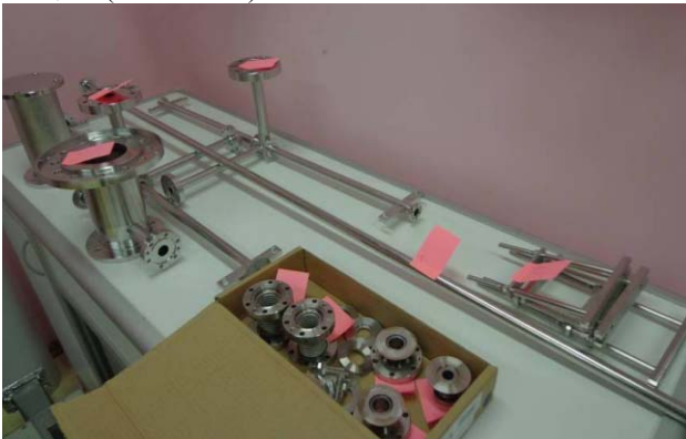
Рис. 5.3.12. Элементы вакуумной системы плазменной секции.
