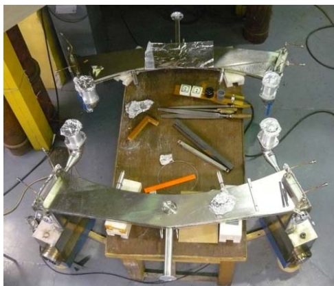
Рис. 5.1.15. Новые вакуумные камеры с дополнительными инфлекторными пластинами.
