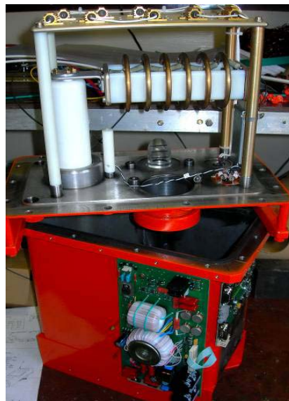
Рис.7.1.5. Оборудование прецизионной системы стабилизации напряжения 60 кВ.
