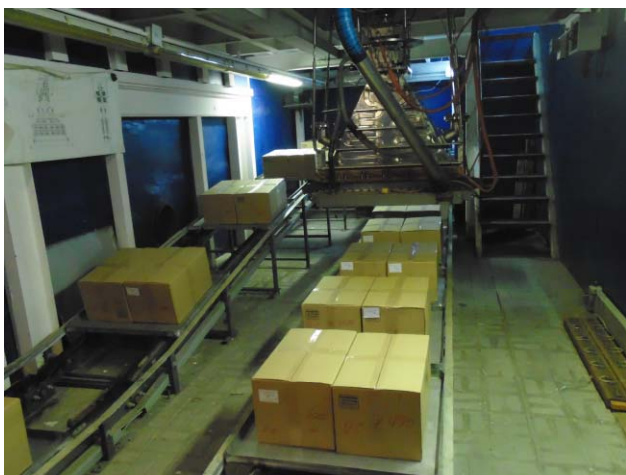
Рис. 8.1.2. Коробки с медицинскими изделиями (одноразовой одеждой) на конвейер облучательного центра и выпускное устройство ускорителя ИЛУ-10.
