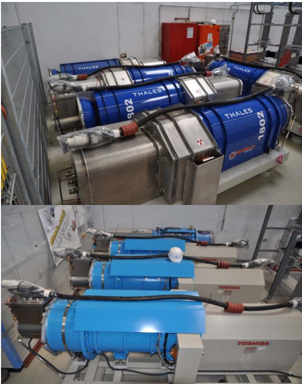
Рис. 5.6.3. Места хранения прошедших испытания клистронов с Соединительными модулями перед их установкой в туннель XFEL.
