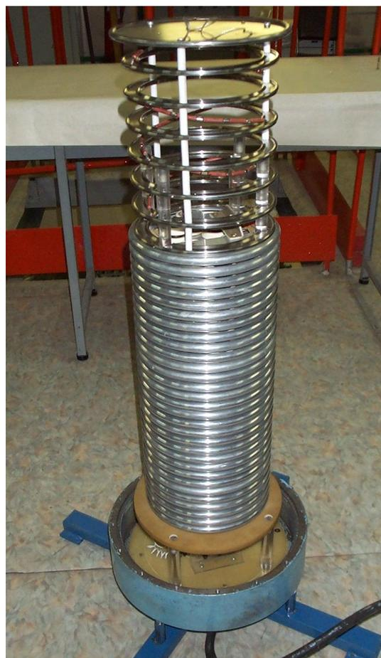
Рисунок 32. Каскадный генератор.
