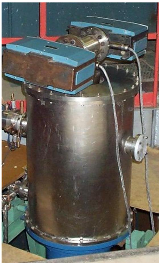
Рисунок 31. Высоковольтный вакуумный стенд.
