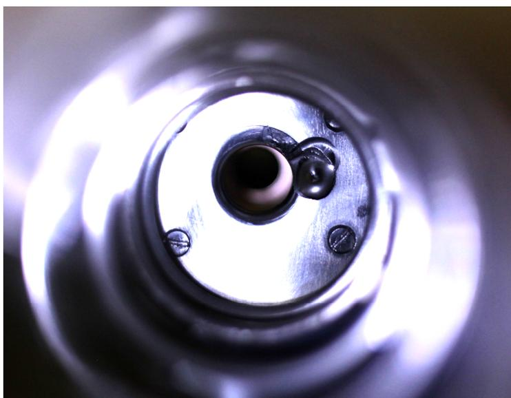
Рисунок 67. Фотография диафрагмы высоковольтного электрода.
