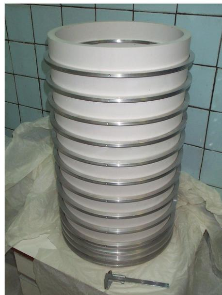
Рисунок 11. Керамические изоляторы и электроды газовой части проходного изолятора.
