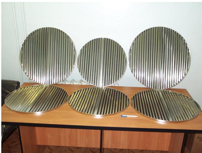
Рисунок 8. Жалюзи вакуумных ускоряющих электродов.
