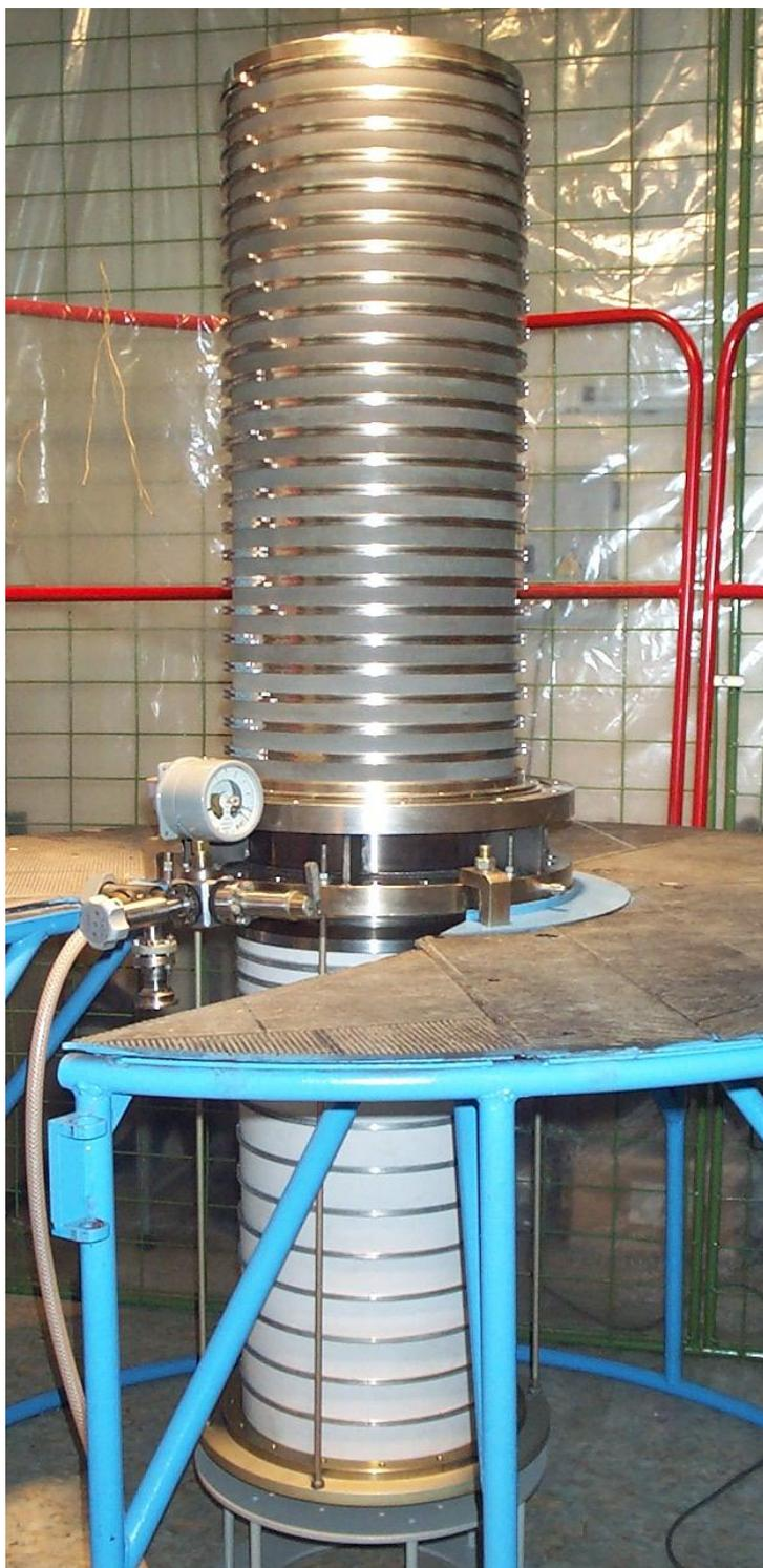
Рисунок 9. Общий вид проходного изолятора в сборе.
