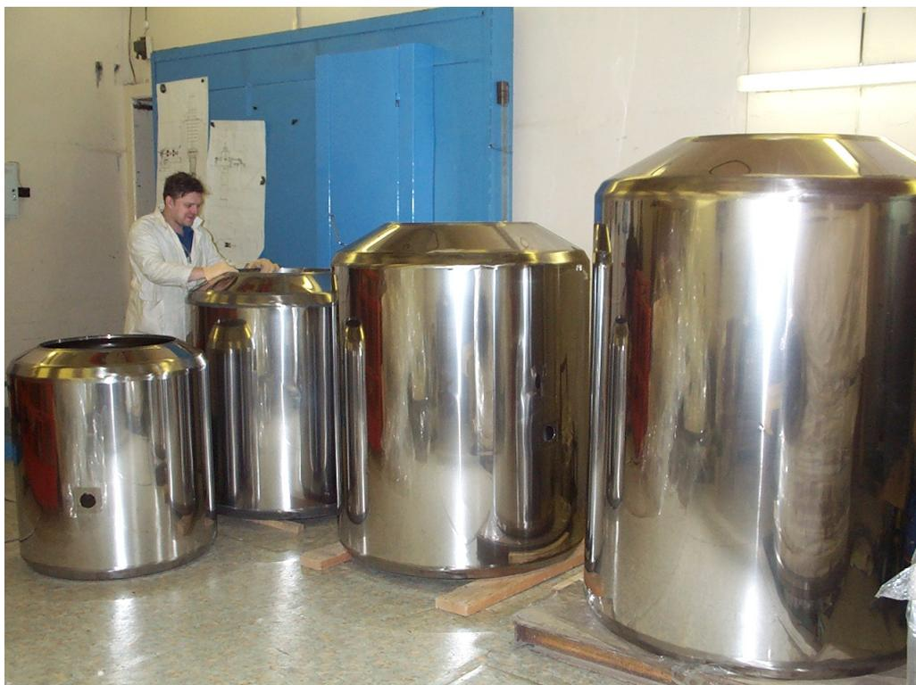
Рисунок 4. Промежуточные цилиндрические электроды-экраны.
