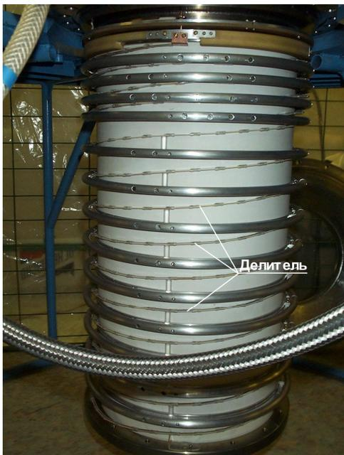
Рисунок 12. Газовая часть проходного изолятора (в сборе) с делителем снаружи.
