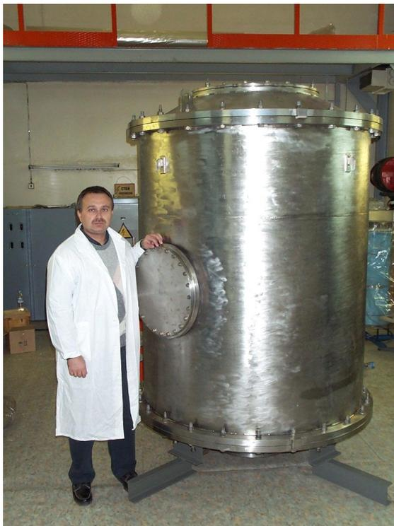
Рисунок 7. Вакуумный бак ускорителя-тандема.
