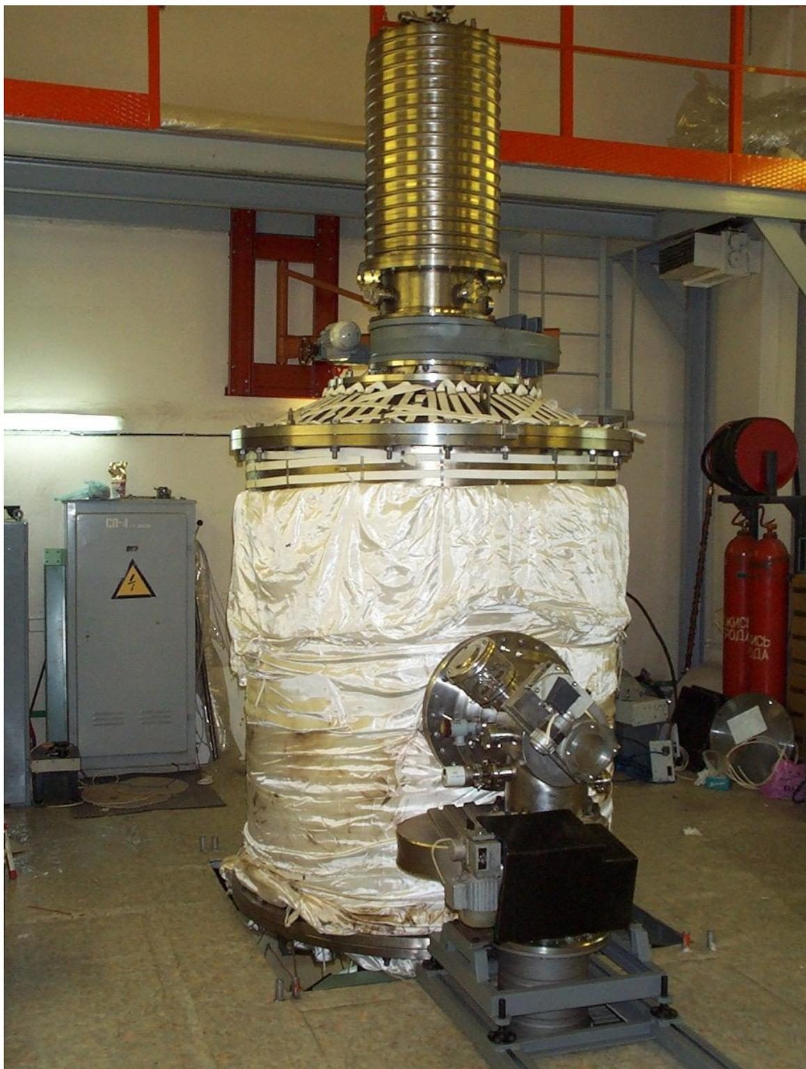
Рисунок 46. Вакуумный бак ускорителя-тандема, криогенный и турбомолекулярный насосы.
