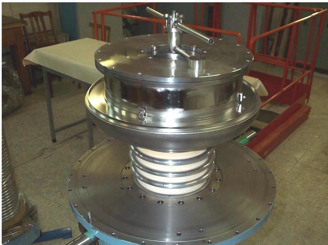
Рисунок 40. Перезарядная мишень с газовым объёмом и проходной изолятор.
