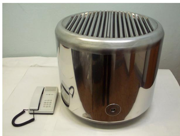
Рисунок 6. Высоковольтный электрод.
