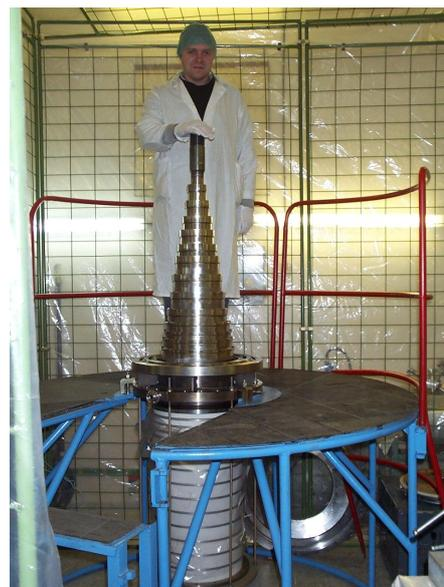
Рисунок 15. Коаксиальные трубы в сборе.
