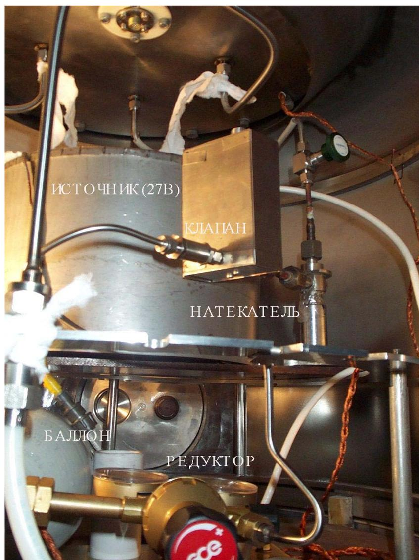
Рисунок 20. Система подачи газа в перезарядную мишень.
