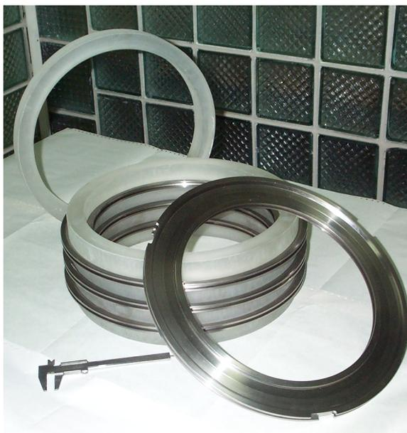
Рисунок 10. Стекланные изоляторы и электроды вакуумной части проходного изолятора.
