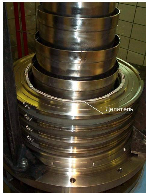
Рисунок 13. Вакуумная часть проходного изолятора (частично разобранная) с делителем внутри.
