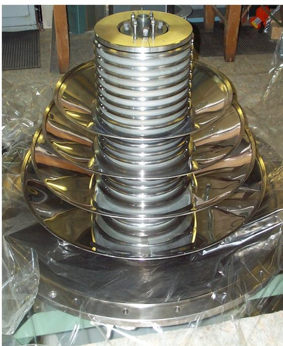
Рисунок 16. Расположение электродов-экранов на изоляторе.
