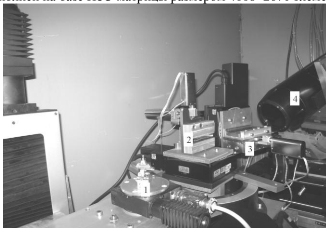
Рис.1. Увеличитель на основе асимметрично срезанных кристаллов. 1 – исследуемый образец, 2, 3 – первый и второй асимметрично срезанные кристаллы, 4 – двухкоординатный детектор.
