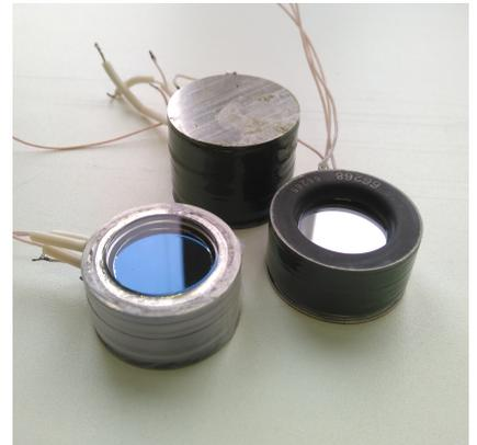
Рис. 5.10: Схема прибора (слева) и общий вид детекторов (справа) на основе МКП.
