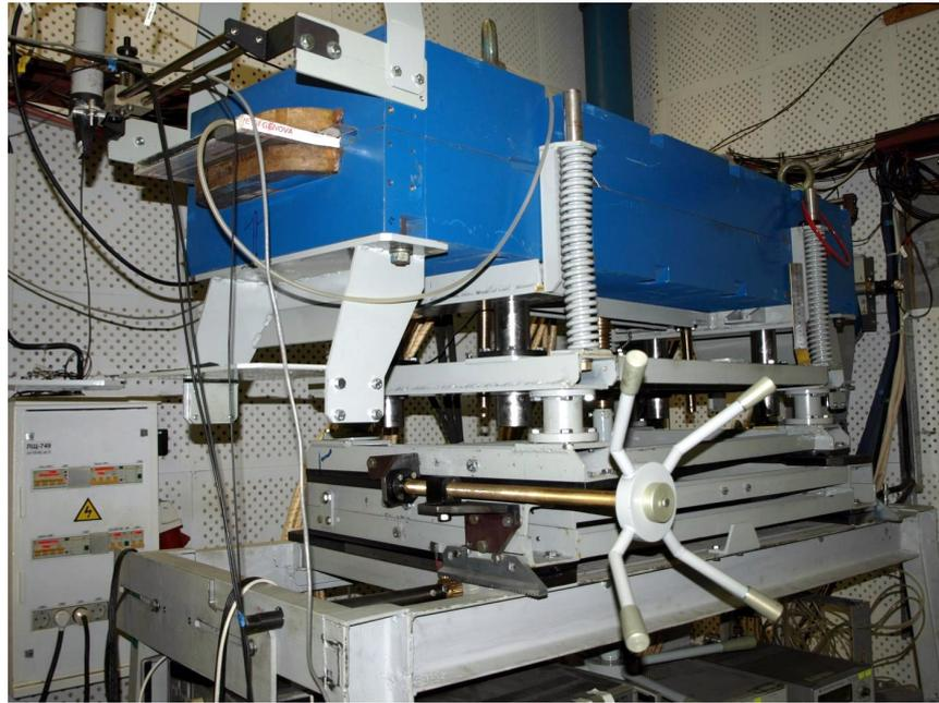
Рис. 2.33: Вид платформы для установки поворотного магнита с системой его перемещения.
