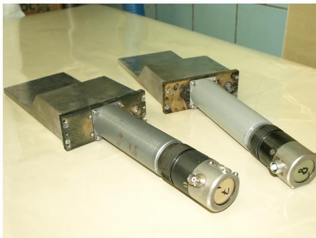
Рис. 2.4: Внешний вид сцинтиляционных счетчиков со сбором света с помощью световодов, размер сцинтиллятора  $100 \times 100 \text{ мм}^2$ .
