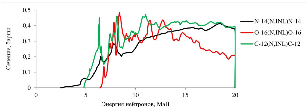
Рисунок 2.20 – Сечения неупругого рассеяния нейтронов с образованием характеристических  $\gamma$ -квантов:  $^{14}\text{N}$  2312.59(1) кэВ;  $^{16}\text{O}$  6128.63(4) кэВ;  $^{12}\text{C}$  4438.03 кэВ
