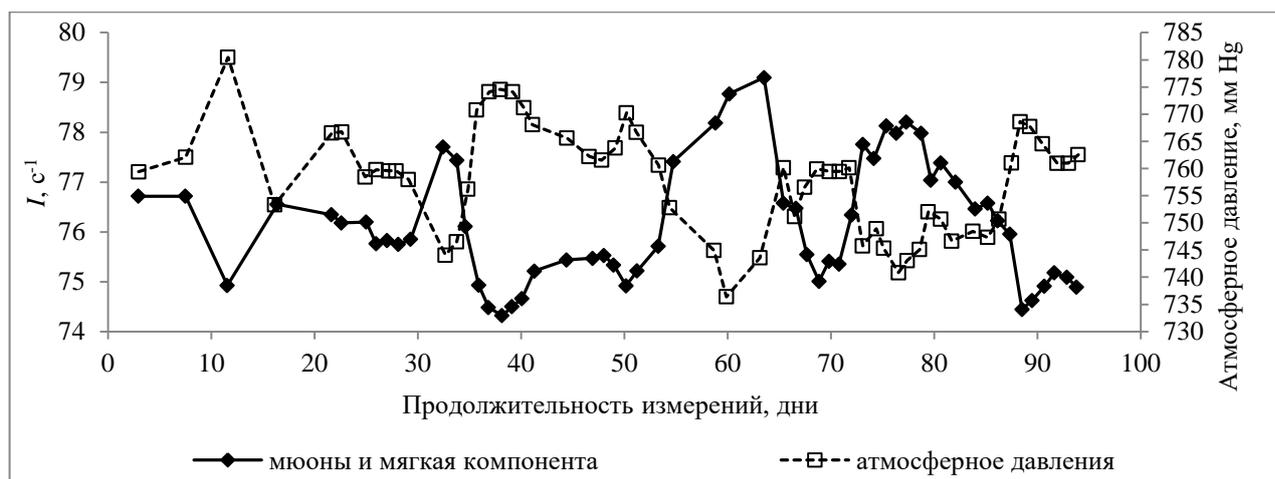
Рисунок 5.12 – Корреляция между атмосферным давлением и интегральным счетом детектора  $\tilde{\nu}_e$  в области мюонной и мягкой компоненты космического излучения. Измерения выполнены с 23.01.2014 по 15.04.2014
