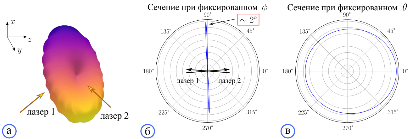
Рисунок 3.15 — Угловое распределение интенсивности излучения при \alpha=5^\circ : схематическое трёхмерное распределение (а); распределение по полярному углу в координатах (x, z) (б); распределение по азимутальному углу в системе координат, сонаправленной к оси лазера 1 (с)
