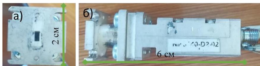
Рисунок 1.4 — Фотография датчика ТГц излучения
