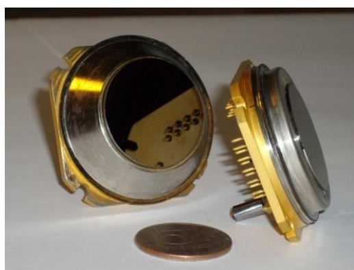
Рисунок 1.4 – внешний вид неохлаждаемого матричного микроболометрического приемника: а) без внешнего кожуха; б) в кожухе
