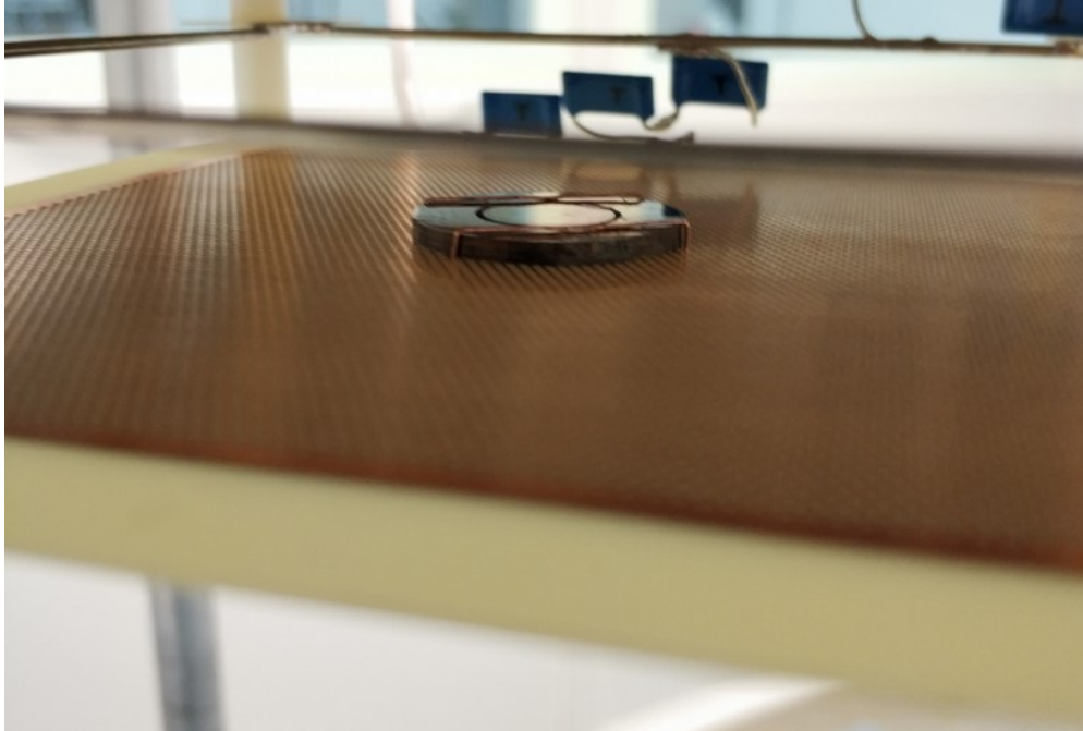
Рисунок 2.9 — Фотография альфа-источника ^{238}\text{Pu} , закрепленного на катоде криогенного детектора
