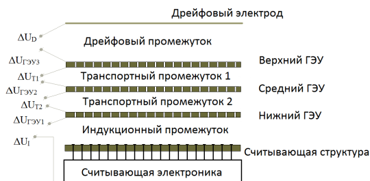
Рисунок 2 — Схема детектора на основе трёхкаскадных ГЭУ
