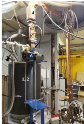
Рисунок 4 – Стенд для испытания клистрона: 1 и 2 соленоид и система группировки пучка внутри соленоида соответственно, 3 – измерительные волноводные ответвители, 4 – выходное вакуумное волноводное окно, 5 – согласованная водяная нагрузка, 6 – магниторазрядный насос
