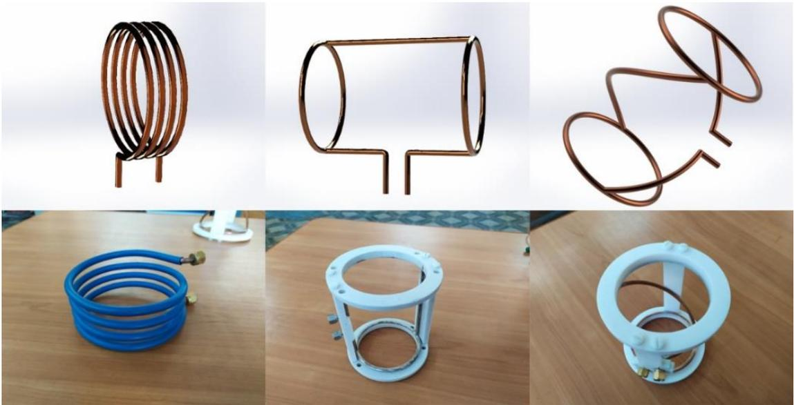
Рисунок 17 — Типы использованных ВЧ антенн: витковая ( $d_a=3.6 \text{ см}$ ,  $m=0$ ); NIII ( $d_a=16 \text{ см}$ ,  $m=\pm 1$ ); Н-Н ( $d_a=15 \text{ см}$ ,  $m=\pm 1$ ); диаметр медной трубки  $d=6 \text{ мм}$
