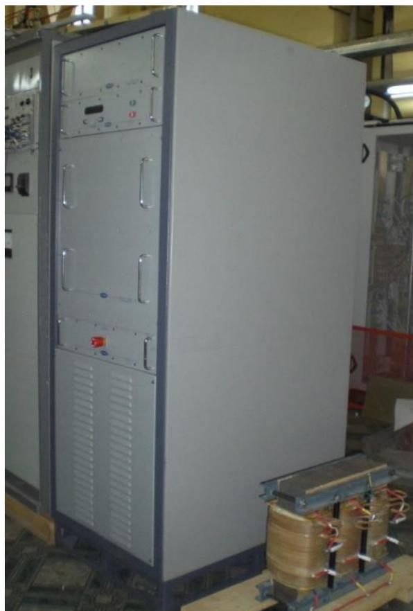
Рисунок 18 — Промышленный ВЧ генератор COMDELL CX25000-S, мощность до 25 кВт, рабочая частота 13.56 МГц
