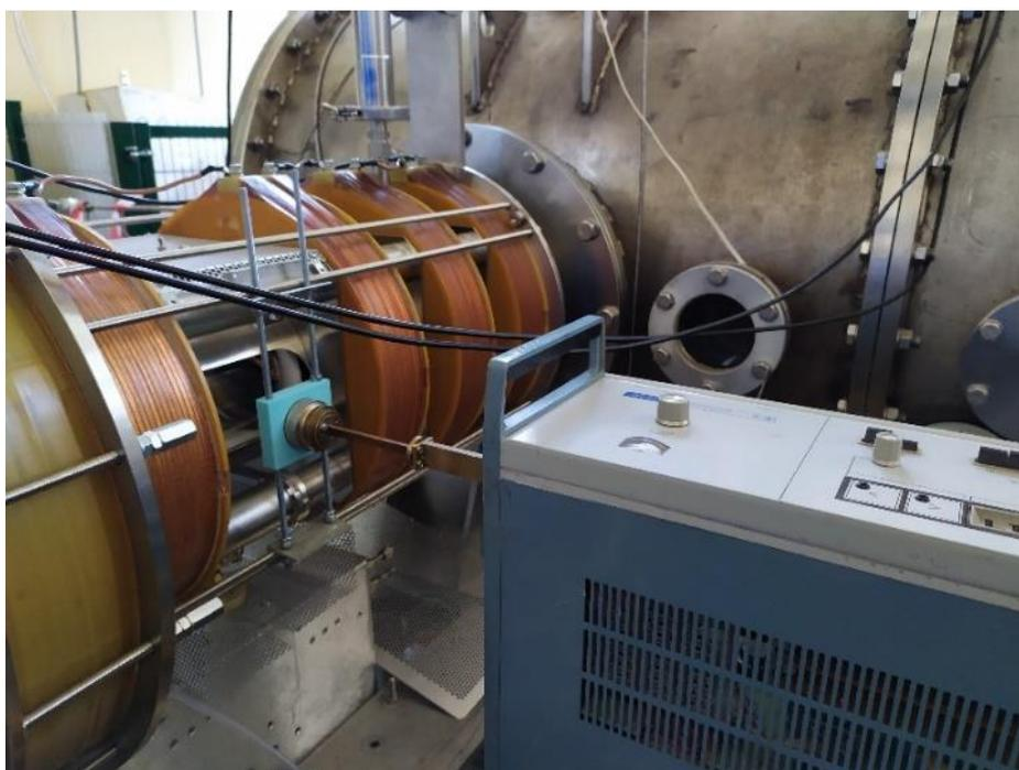
Рисунок 27 — Расположение СВЧ генератора и точки измерения плотности относительно источника
