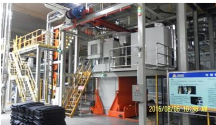
**Рисунок 1.9.** Ускоритель ЭЛВ в местной радиационной защите в составе линии по производству авторезины.
