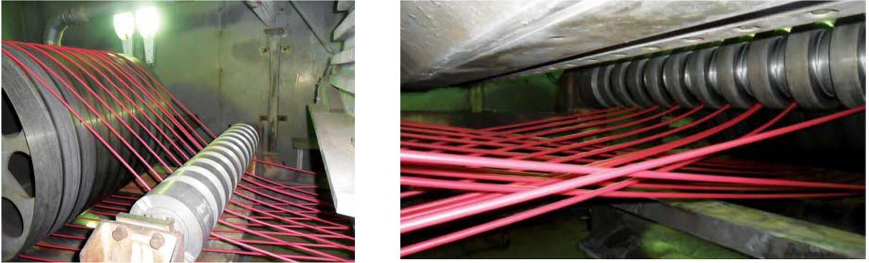
**Рисунок 1.8.** Расположение кабельной заготовки на подающем барабане и направляющем ролике транспортной системы облучения (слева) и под выпускным окном ускорителя (справа).
