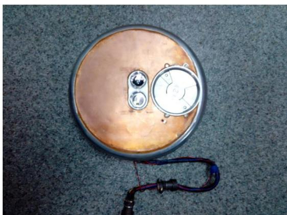
**Рисунок 2.31.** Медная обкладка ёмкостного датчика для измерения пульсаций.
