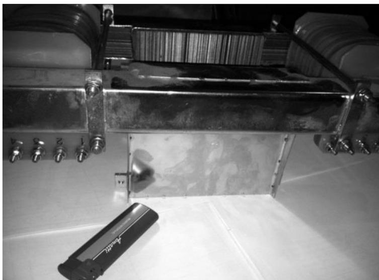
**Рис 3.5.** Система магнитов, отклоняющих пучок вдоль выпускного окна.
