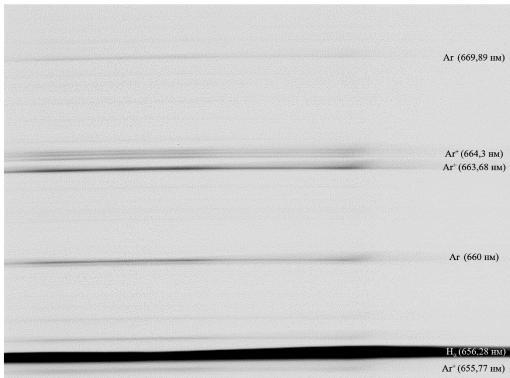
Рисунок 29 – Фотография спектра водородно-аргоновой плазмы в диапазоне 653 – 667 нм
