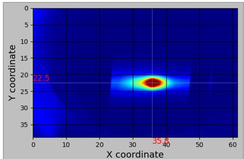
Пучок в спектрометре в конце ускорителя. Предоставлено А. Е. Левичевым.
