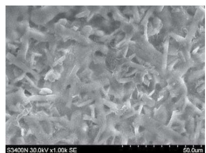
На фотографии, сделанной на сканирующим электронным микроскопе, показана поверхность одного из образцов новой керамики. Одно деление шкалы в нижней части рисунка — 5 микрон.
