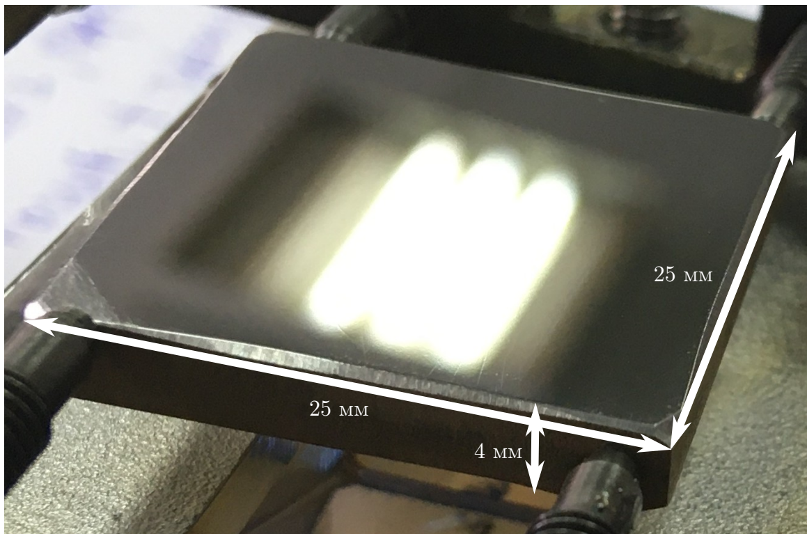
Рисунок 2.3 — Фото образца в виде полированной до зеркального блеска вольфрамовой пластины, закрепленной в мишенедержателе установки БЕТА
