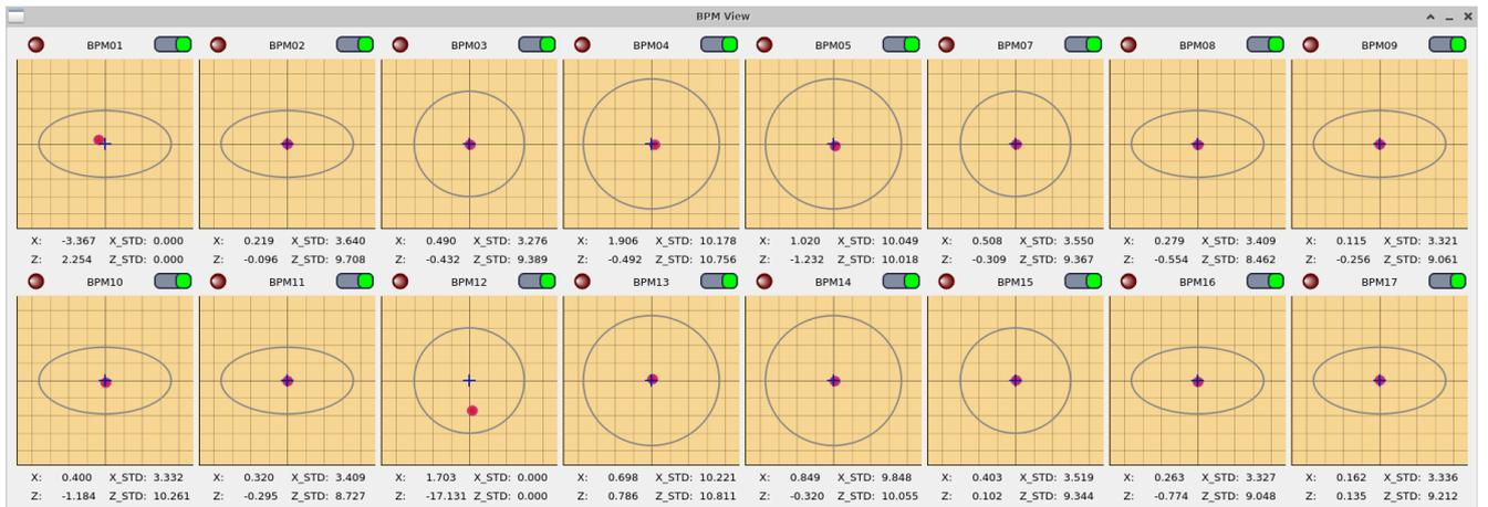
Рисунок 4.6 — Отображение положения пучка накопителя-охладителя в местах расположения датчиков положения пучка
