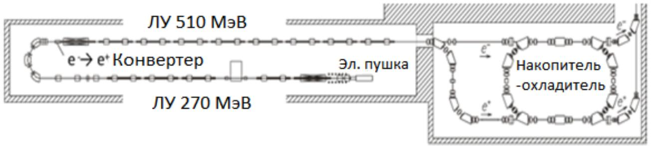
Рисунок 1.2 — Схема инжекционного комплекса ВЭПП-5 (без каналов К-500)
