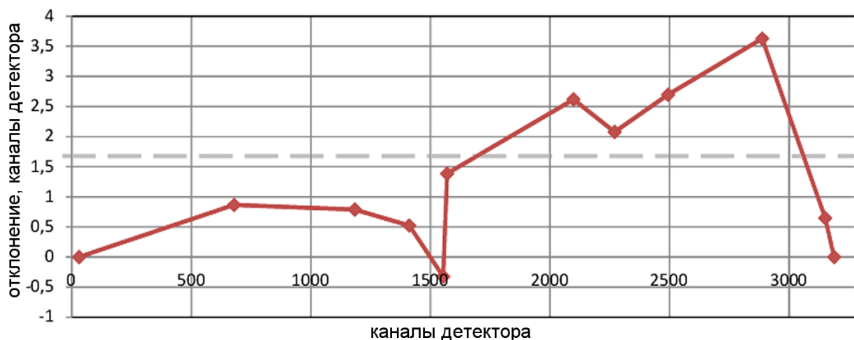
Рисунок 6.5. Отклонение реальной характеристики преобразования от линеаризованной.
