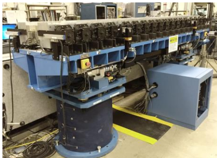
Рисунок 6. Полноразмерный (3,4 м.) прототип горизонтального ондулятора LCLS-II с динамической компенсацией магнитной силы (HGVP).
