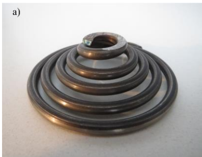
Рисунок 4. а) коническая пружина, используемая в механизме компенсации магнитной силы; б) нагрузочная характеристика для идеальной пружины.
