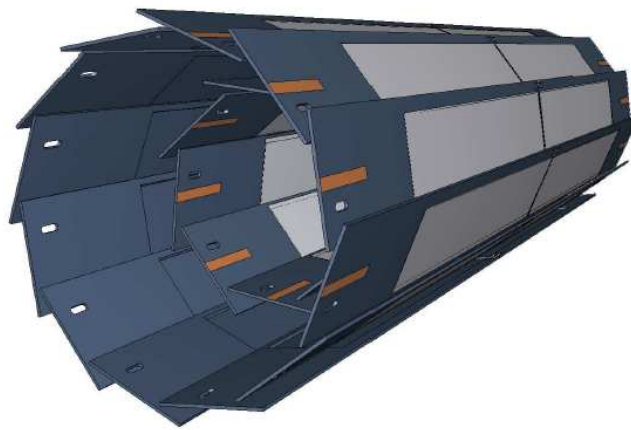
Рис. 70. Схема расположения сенсоров PXD детектора BelleII
