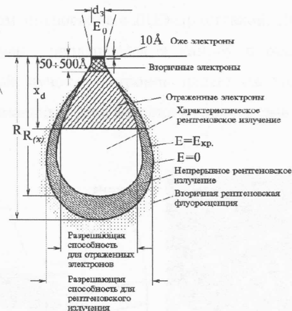
Рисунок 24: Схематичное изображение глубины различных взаимодействий электронного зонда с образцом
