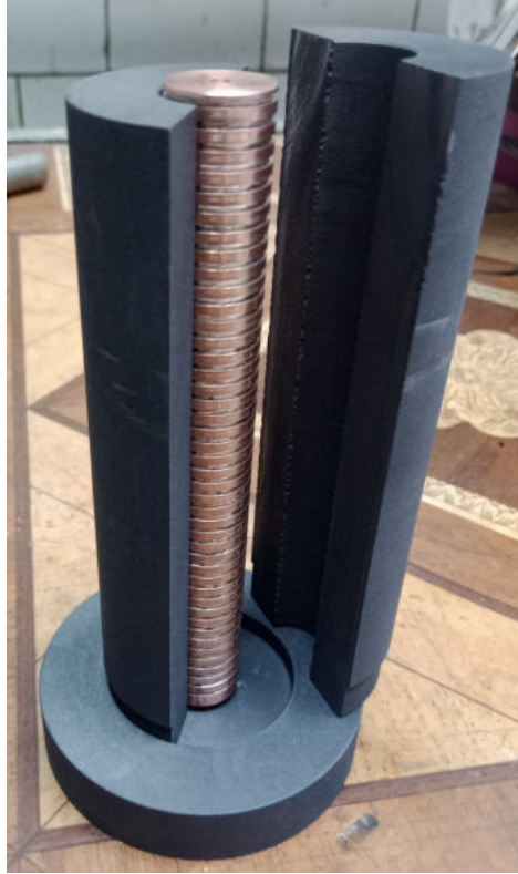
Рисунок 3.14 — Графитовая оснастка с паяной структурой
