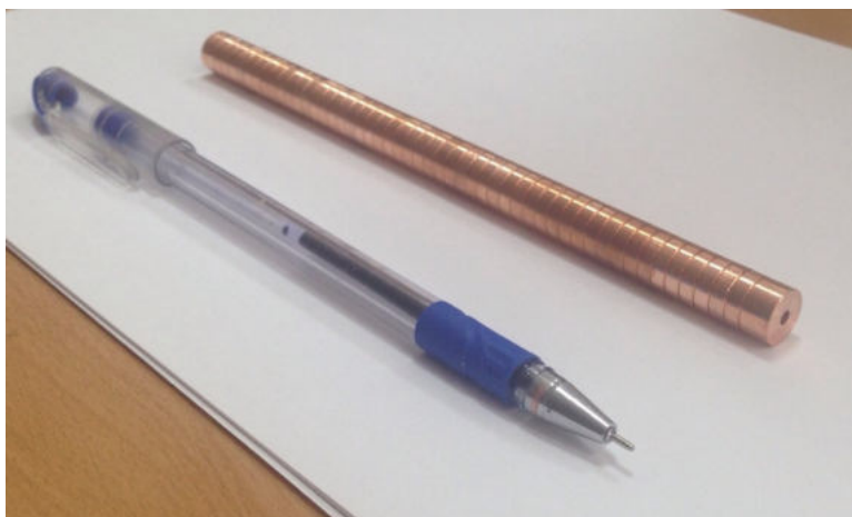
Рисунок 3.1 — Первый прототип структуры резонаторов W-диапазона
