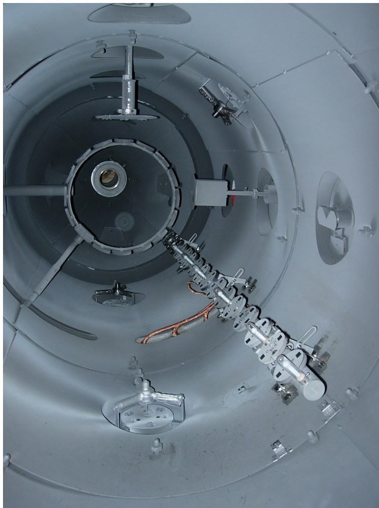
Рис. 10: Продольная и круговая сборки магнитных зондов
