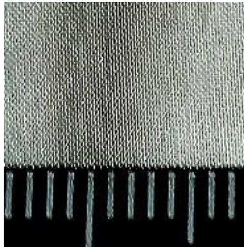
Рис.19: Мелкоструктурная молибденовая сеточка
