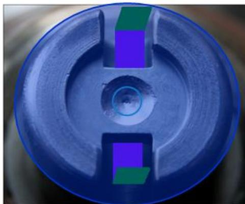
*Рис. 16. Фото магнетронной модификации катода; синим показано положение анодной крышки, фиолетовым – положение внутреннего анода*
