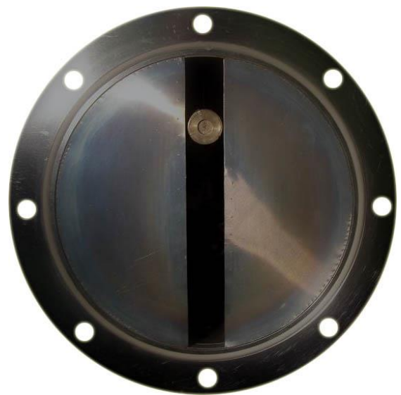
Рисунок 6.1.1. Металлическая пластина с пазом, установленная в плоскости вытягивания ионов имитирует влияние плазменной сетки ионно-оптической системы.
