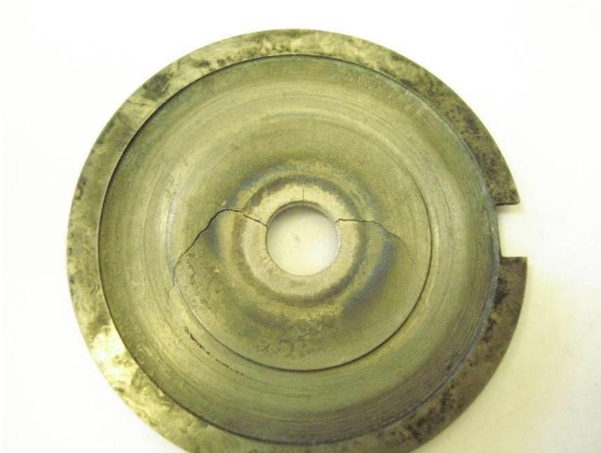
*Рис. 11. Вторая диафрагма дугового канала, подверженная растрескиванию*
