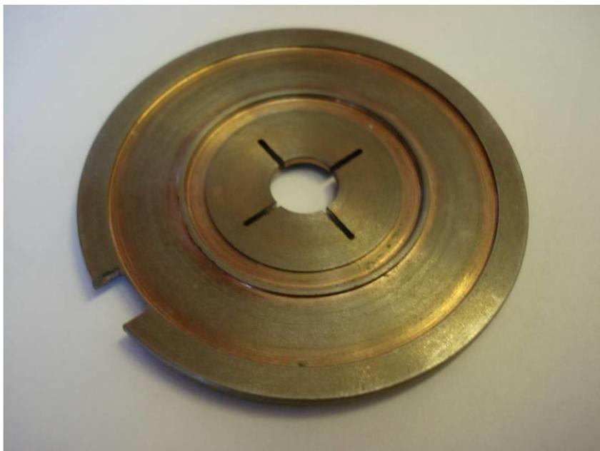
*Рис.12. Вторая диафрагма дугового канала с радиальными разрезами*
