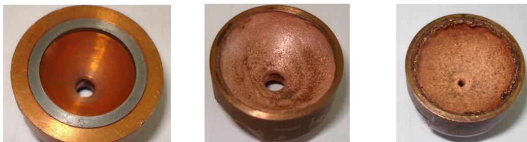
*Рис. 5. Износ катода*
