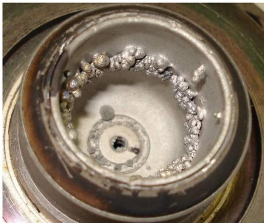
*Рис. 7. Катод после 2000 двухсекундных импульсов.*
