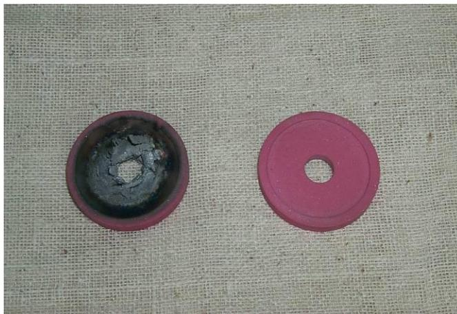
*Рисунок 8. Изображены керамические прикатодные диафрагмы изготовленные из керамики 22-ХС. Слева диафрагма после 500 с. интегрального времени работы в импульсах длительностью 0.5-1с., справа не использованная диафрагма.*
