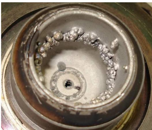
*Рис. 21. Катод сильный износ*
