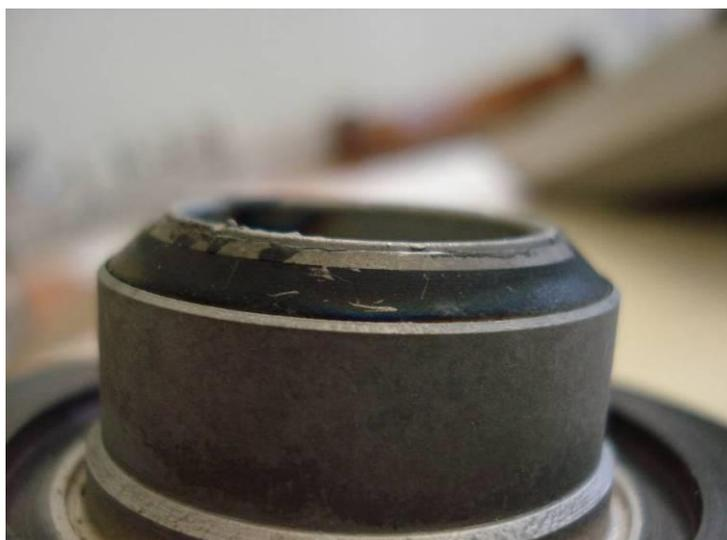
Рис. 10. Катод с изоляционным кольцом из нитрида бора, после примерно 2000 двухсекундных импульсов.
