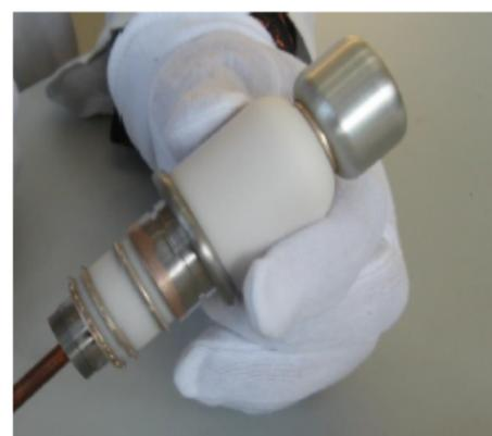
Рис.12. Исходная конфигурация нейтроногенерирующей трубки
