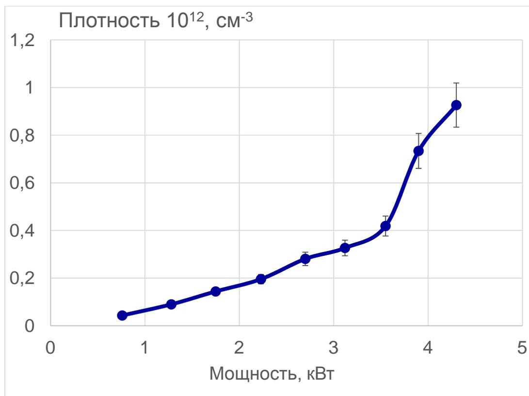
Рис. 11. Зависимость плотности плазмы от подводимой ВЧ мощности.
