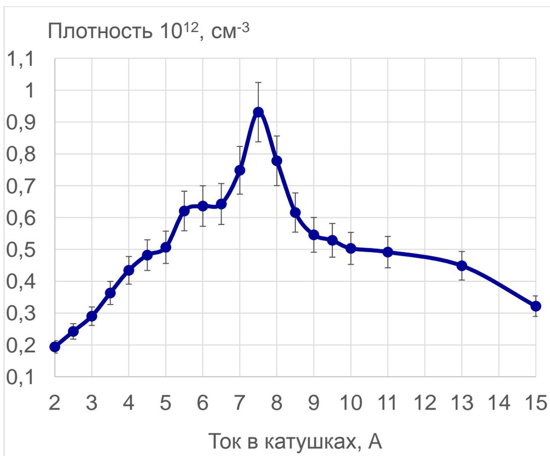
Рис. 12. Зависимость плотности плазмы от тока в магнитных катушках.
