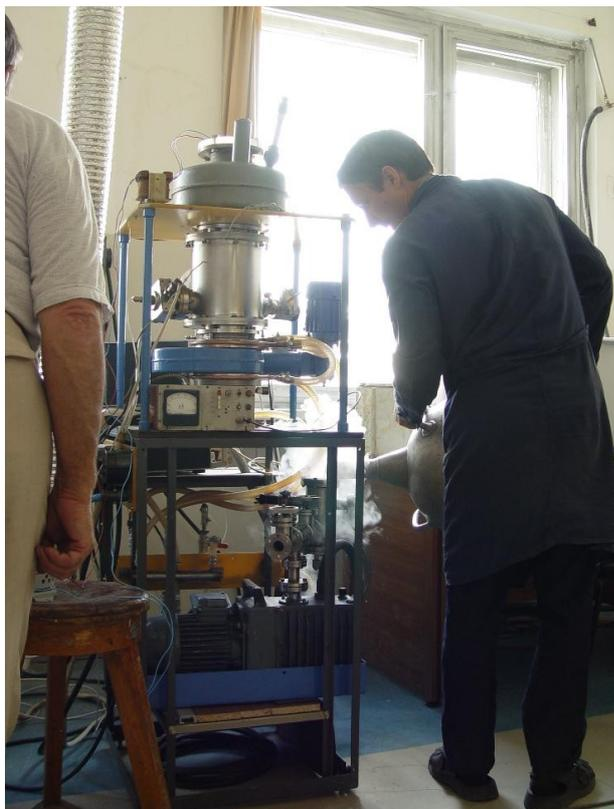
Рис. 4. Стенд для напыления лития.
