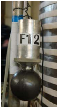
Рис. 3. Блок детектирования мощности дозы фотонного излучения.
