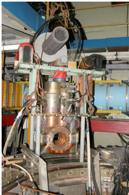
Рис. 2. Общий вид ускоряющей системы и питающего усилителя мощности.
