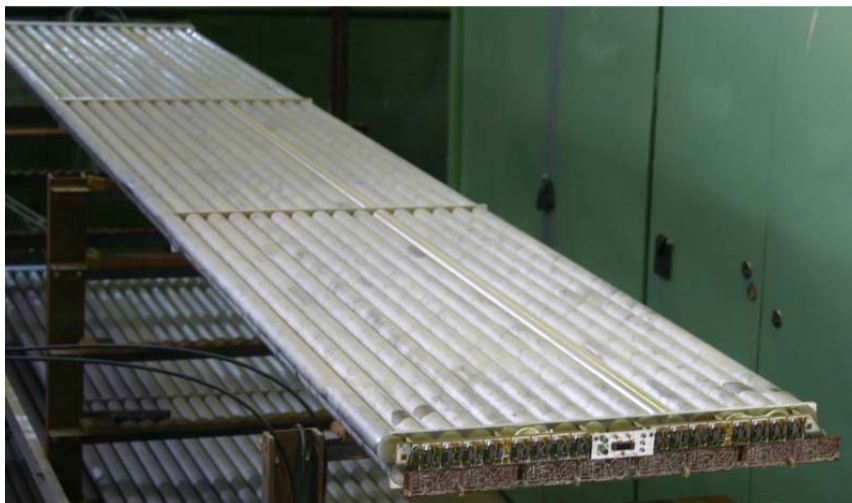
Рис. 42: Блок мюонной системы на стенде. Защитный кожух снят.
