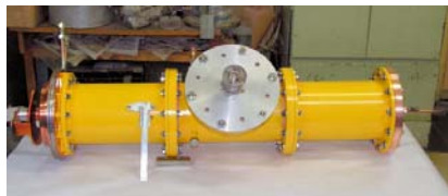
Рис. 26. Общий вид ввода мощности.
