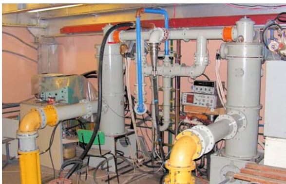
Рис. 28. Два генератора с коаксиальными фидерами.
