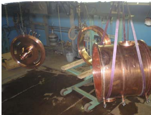
Рис. 18. Элементы ускоряющей структуры перед сборкой.
