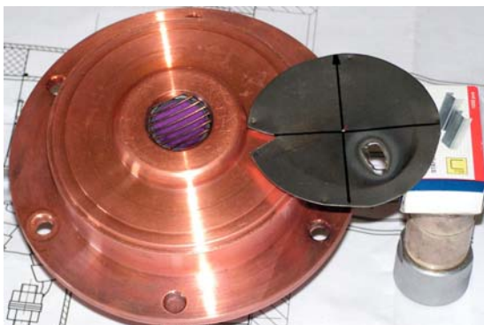
Рис. 30. След пучка на фольге и катодно-сеточный узел (диаметр сетки 20 мм).
