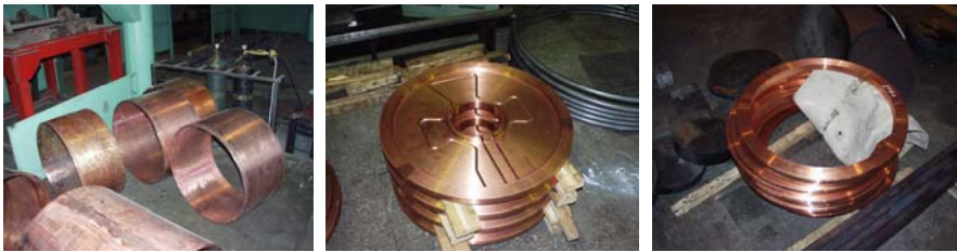
Рис. 19. Заготовки элементов ускоряющей структуры: а) обечайки; б) торцевых стенок; в) соединительных фланцев обечайки.
