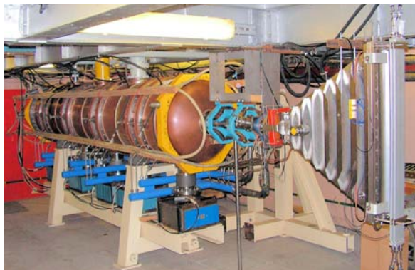
Рис. 29. Ускоряющая структура прототипа с системой развертки в бункере.
