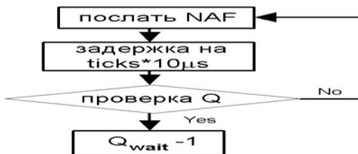
Рис. В.1. Схема цикла обслуживания NAF.
