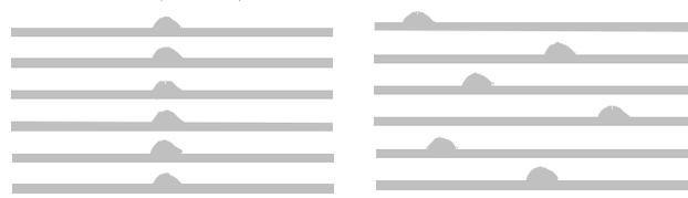
Рис. 2. Когерентное воспроизведение шероховатостей от слоя к слою (а) вызывает усиление интенсивности РДР пропорционально  $N^2$  в соответствии с условием (1.2), в то время как интенсивность РДР от того же числа не коррелированных шероховатостей (б) пропорциональна  $N$ . Подчеркнем, что и тот и другой случай дают одинаковые вклады в дисперсию шероховатости,  $\sigma$ .
