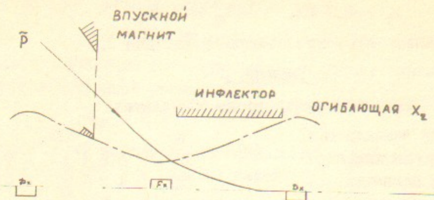
Рис.11. Схема впуска антипротонов в синхротрон-замедлитель
