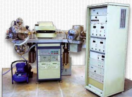
Анализ изотопного состава урана и плутония в твердой фазе
