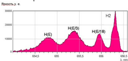
Рис. 4. Уширение линий, измеренное с разрешением \lambda/\delta\lambda = 60000 для 50 кВ, 2.5 А пучка.
